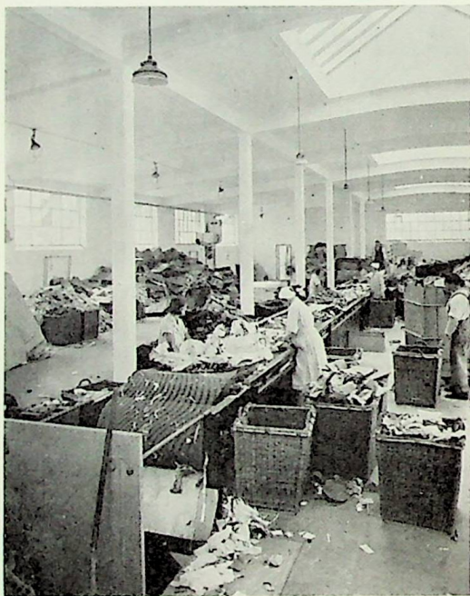
Sortering af gammelt papir på transportbånd på kartonfabrikken
