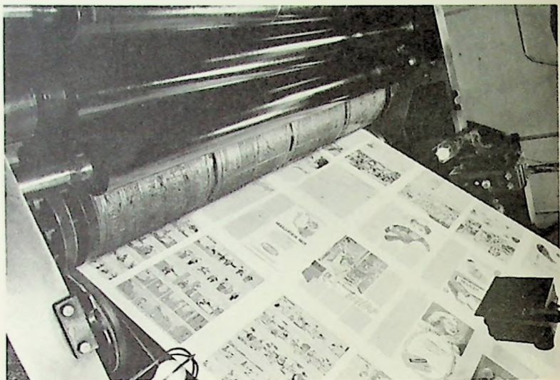
Et af de 10 trykværker på maskinen
